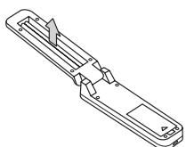
6.2 Меры безопасности: аппарат автоматически отключится, если он перевернут (лампа направлена вверх). Дезинфектор вновь начнёт работать, как только он будет развернут лампой вниз.
