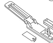
Закрыть крышку батарейного отсека.
